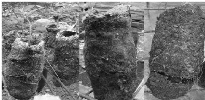
Figura 4 - Tubetes biodegradáveis que apresentaram o aparecimento de fungos e rachaduras, após a quarta semana de crescimento das mudas Fonte: Elaborada pelos autores
