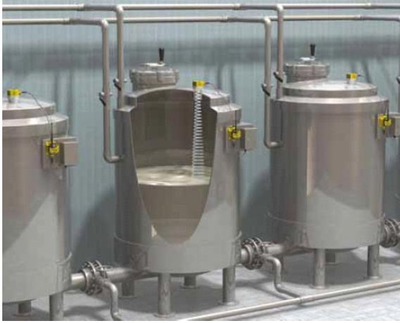
**Figura 11** - Dispositivo Wireless aplicado a medição de fluidos em tanques
