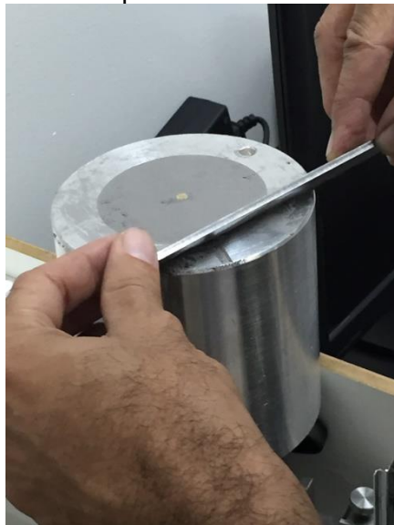
Figura 8 - Nivelamento do material particulado na câmara de fusão.
