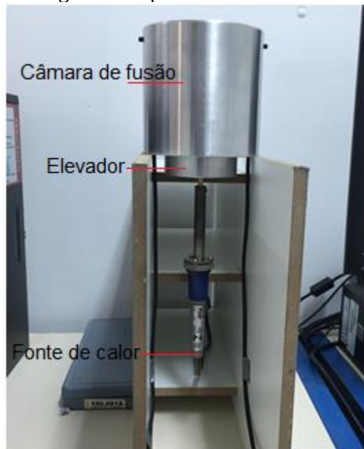
Figura 7 - Esquema de montagem do experimento.
