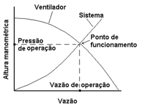
Figura 3 - Ponto de funcionamento do sistema Fonte: SILVA, 2008
