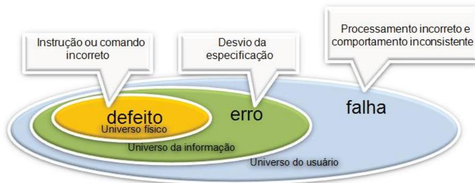
**Figura 1** - Diferença entre defeito, erro e falha, conforme Neto (2007).
