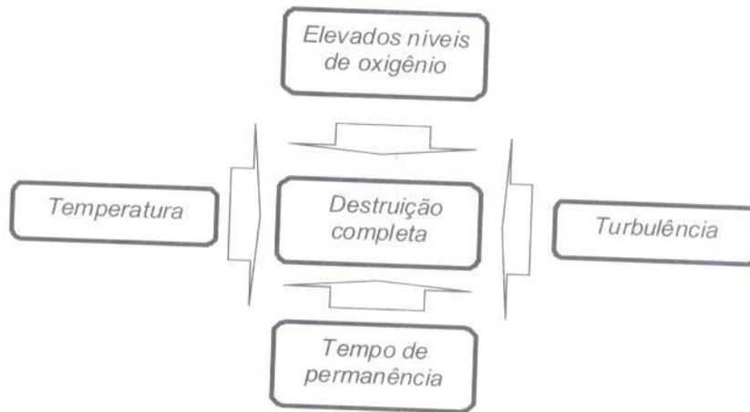
**Figura 14:** Condições necessárias para a incineração completa do RSU
