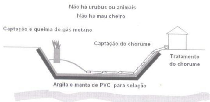
**Figura 12:** Desenho esquemático de um aterro sanitário
