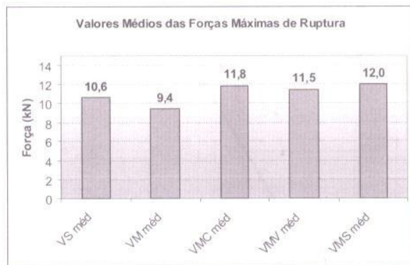
Figura 4- Gráfico dos valores médios das forças de ruptura de cada lote ensaiado
