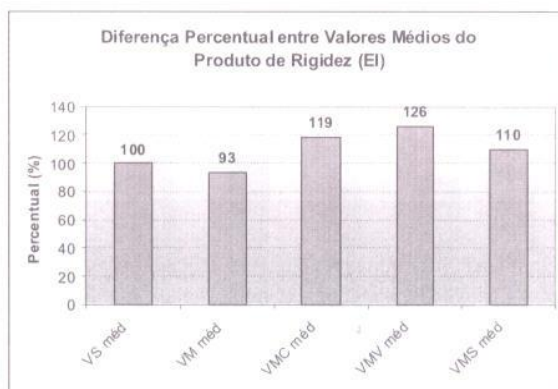
Figura 9- Diferença percentual entre valores médios do produto de rigidez dos lotes ensaiados
